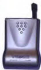
Илл. 59. Приемник фирмы Vesco из переносного комплекта, рекомендуемого для проведения тифлокомментирования в необорудованных помещениях или на улице.
