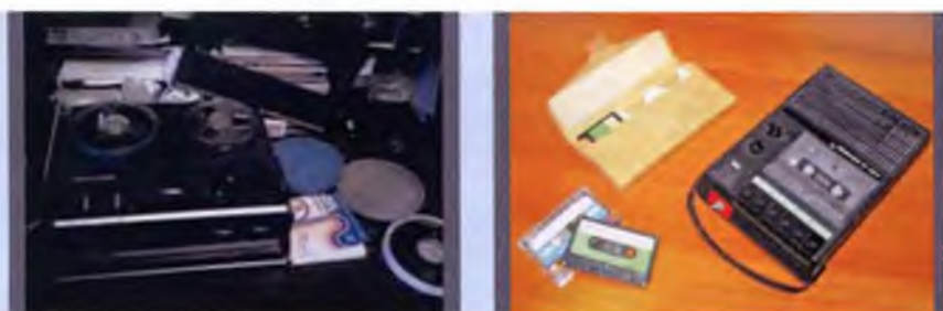
Илл. 16. Специализированные аппараты для прослушивания «говорящих» книг и звукофильмов для слепых: катушечный магнитофон «Дайна» (слева) и компакт-кассетный проигрыватель «Легенда» (справа). 1970-1980-е гг.
