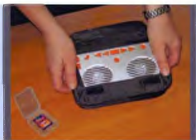
Илл. 55. Современный тифло-флеш-плеер и флеш-карта для прослушивания «говорящих» книг и звукофильмов. На флеш-карте может быть размещено свыше 10 звукофильмов.
